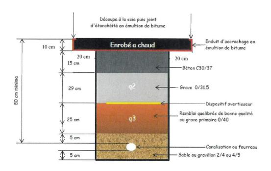
Les matériaux extraits des fouilles et réutilisés pour le remblaiement doivent être contrôlés afin de ne pas introduire des blocs trop important dans la tranchée pouvant à terme endommager les conduites.
